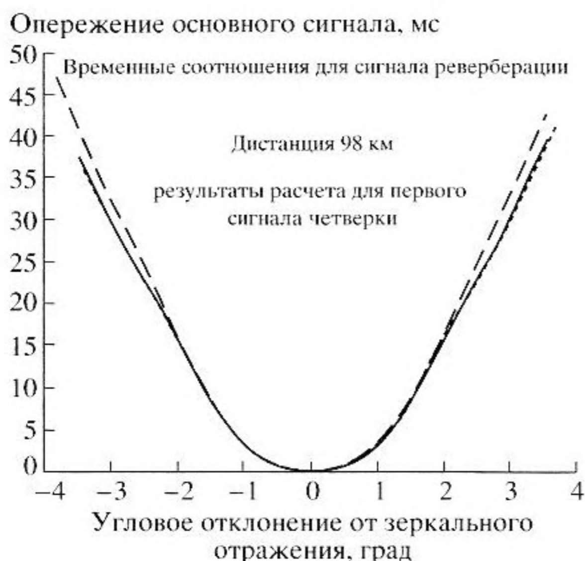
Рис. 5. Разница времени распространения прямого (зеркально отраженного поверхностью) и рассеянного поверхностью океана (реверберационного) сигнала. Ее зависимость от углового (в вертикальной плоскости) отклонения рассеянного сигнала от зеркального отражения. Результаты расчета, выполненного для первого сигнала четверки. Азимутальное отклонение отсутствует. Глубина источника 150 м, приемника: 100 м (—), 20 м (....) и 500 м (---). Расстояние между ними 98 км.
