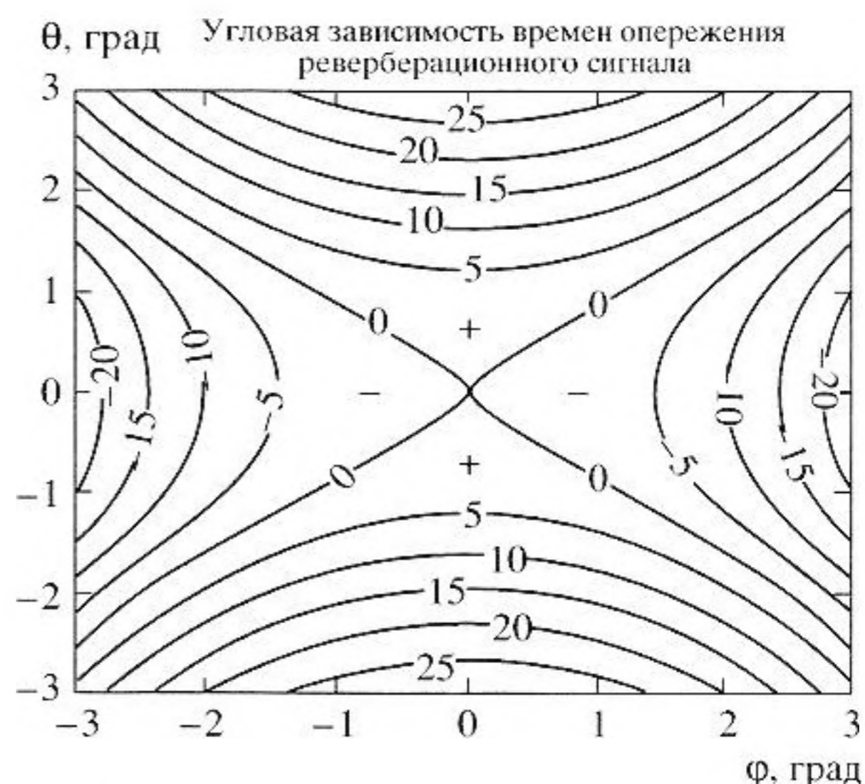
Рис. 6. Угловая (в горизонтальной и в вертикальной плоскости) зависимость разности времен распространения прямого (зеркально отраженного от поверхности океана) и реверберационного сигналов. Числа у изолиний – разность времен распространения в мс. Расстояние между источником и приемником 98 км, глубины погружения: источника 150 м, приемника 100 м. Расчет выполнен для первого сигнала четверки, дважды развернувшегося (благодаря рефракции) на глубине \sim 3300 м. Верхний и нижний сектора, отмеченные знаком “+”, соответствуют опережению реверберационным сигналом прямого сигнала. Левый и правый сектора, отмеченные знаком “-”, соответствуют запаздыванию реверберационного сигнала относительно прямого.
