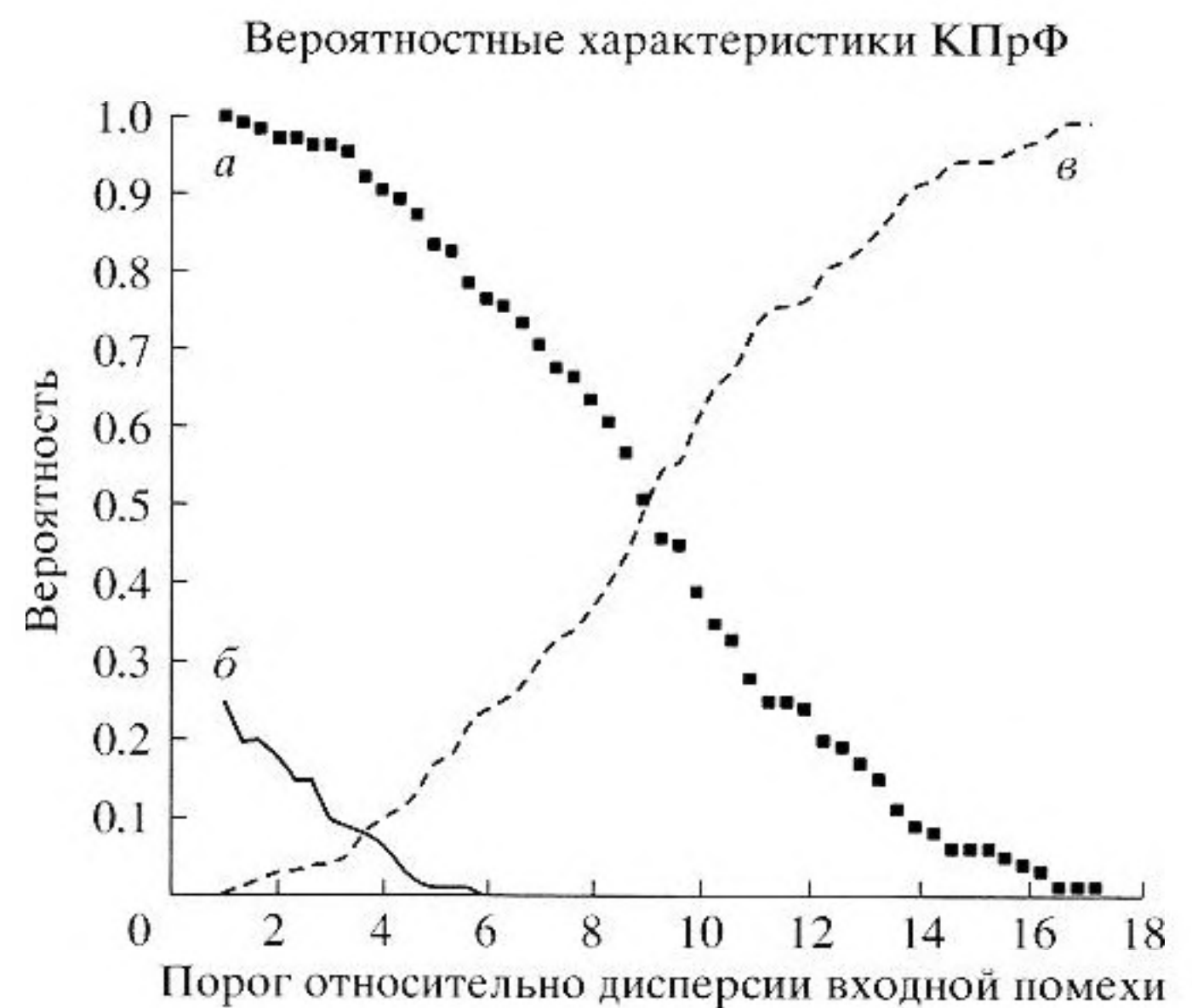
Рис. 4. Вероятностные характеристики КПрФ со САР: а – вероятность обнаружения (точки); б – вероятность ложной тревоги (сплошная линия); в – вероятность пропуска сигнала (пунктирная линия) в зависимости от значения относительного порога.
