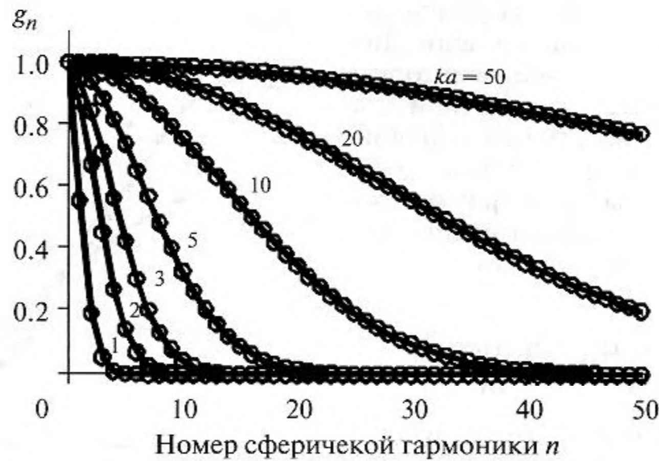
Рис. 5. Нормированные амплитуды сферических гармоник g_n (показаны кружками) в зависимости от их номера n при различных ka .
