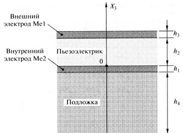
Рис. 1. Схематичное изображение многочастотного резонатора на объемных акустических волнах.
